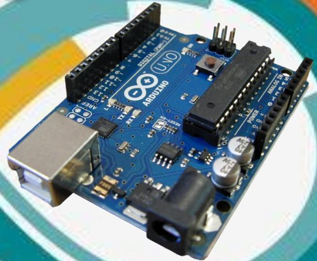
Arduino è una piattaforma di sviluppo open-source basata su una semplice scheda I / O con un  $\mu$ C e un ambiente di sviluppo che implementa hardware e software facile da usare. E' una scheda elettronica di piccole dimensioni con un microcontrollore e circuiteria di contorno, utile per creare rapidamente prototipi e per scopi didattici.
