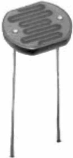
Le fotoresistenze traducono l'informazione luminosa in una variazione di resistenza. Sono realizzate con materiali semiconduttori composti (drogati di tipo N). Le più comuni sono le CdS (solfuro di cadmio) e le PbS (solfuro di piombo). Tra i pregi delle fotoresistenze vi è l'elevata sensibilità e la robustezza. Sono anche economiche e possono essere alimentate sia in corrente continua che alternata.
