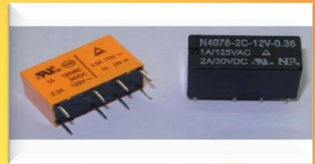
**Il relè è un dispositivo elettrico comandato dalle variazioni di corrente per influenzare le condizioni di un altro circuito. In sostanza, il relè è un deviatore che non viene azionato a mano, ma da un elettromagnete. I contatti del relè costituiscono gli interruttori o gli scambi, il cui stato (aperto o chiuso) dipende dall'eccitazione dell'elettromagnete. Ad esempio, un relè con due contatti può funzionare come interruttore, mentre un relè con tre contatti può funzionare come deviatore.**
