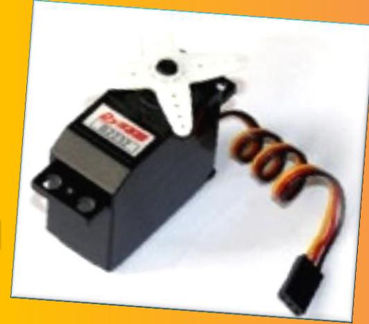
**Quindi le caratteristiche comuni tra i servo sono principalmente, l'angolo di rotazione, la velocità di rotazione e la coppia motrice.**
