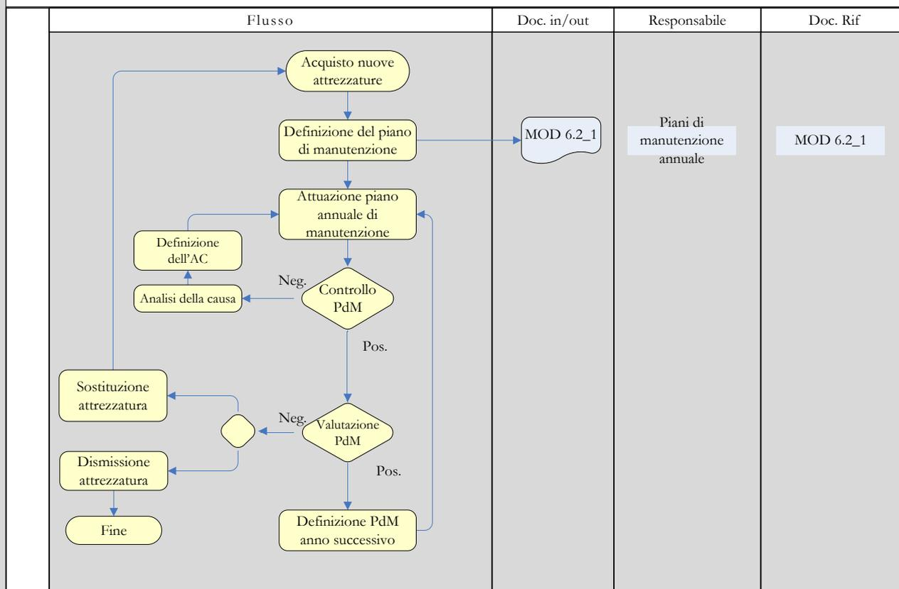
L'attrezzatura è inserita nel piano di manutenzione/controllo che ne gestisce le scadenze e le modalità di intervento registrandone gli esiti.
