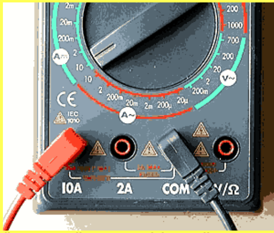
figura 5 - collegamento dei puntali per misure di corrente fino a 10 A.
