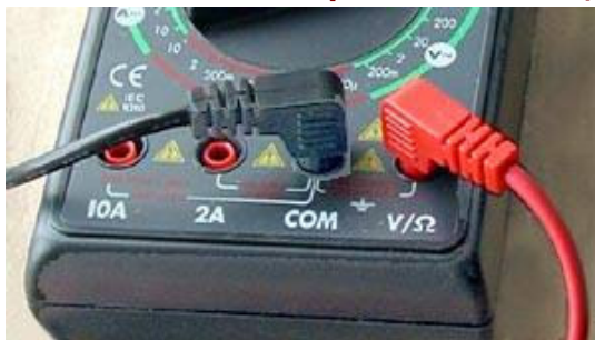
figura 3 - collegamento dei puntali per le misure di tensione e resistenza.
