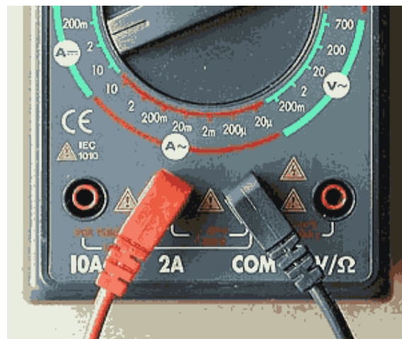
figura 4 - collegamento dei puntali per misure di corrente fino a 2 A.
