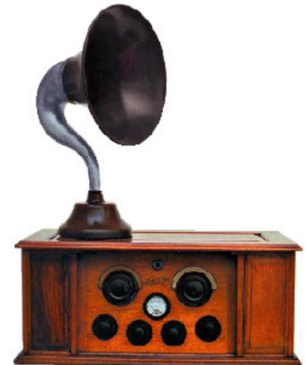
Fig.363 Nel 1924 si pensò di abbellire questi ricevitori racchiudendoli entro dei mobili in legno. Come altoparlante si utilizzava una tromba, quindi la fedeltà sonora risultava ancora molto scadente.
