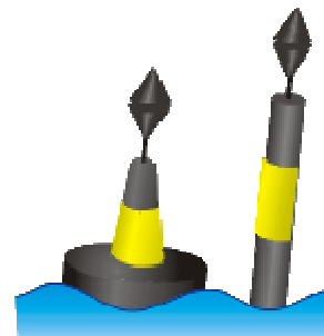
Cardinale Est (passare a Est) - colore : nero - giallo; - miragli : due coni neri puntati verso l'alto e verso il basso uniti per la base - luce : bianca scintillante a gruppi di tre
