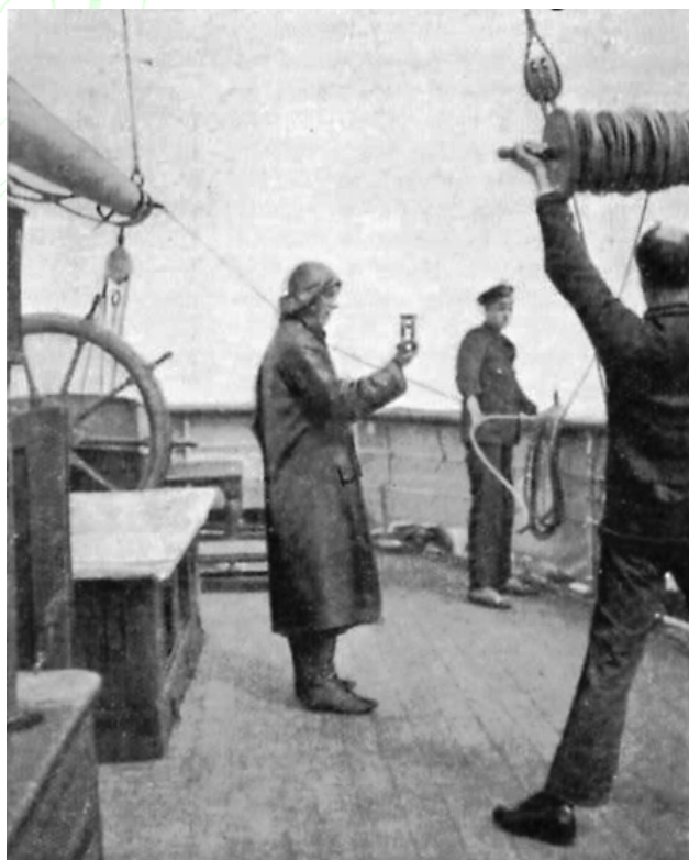
Solcometro a barchetta. Il primo metodo di misurazione della velocità della nave.
