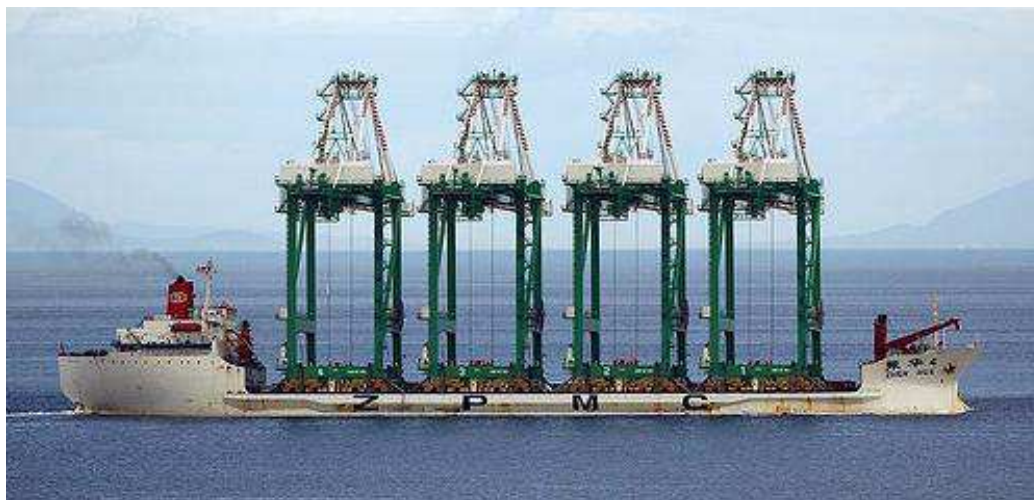
La compensazione speditiva si rende necessaria anche quando si trasportano particolari carichi ferrosi
