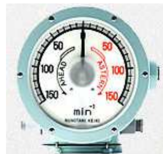
NUNOTANI - Japan. Indicatore analogico dei giri dell'elica (rpm = revolutions per minute; r/min, r·m -1 )
