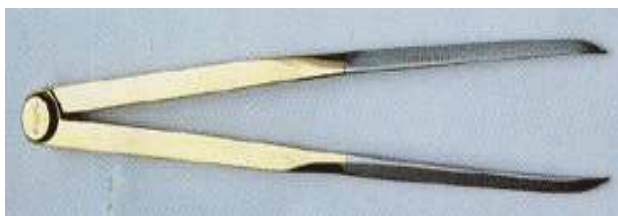
Compassi inglesi a punte fisse, in ottone, con punte in acciaio
