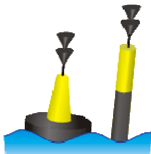
Cardinale Sud (passare a Sud) - colore : nero - giallo; - miragli : due coni neri puntati verso il basso - luce : bianca scintillante a gruppi di sei seguiti da uno lungo.
