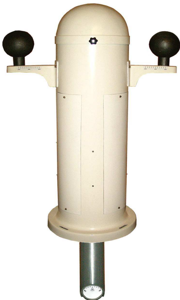
FUSELLI, Genova – Chiesuola in vetroresina (Mod. FF2) per bussola magnetica a riflessione, con dispositivo ottico per la lettura in plancia.
