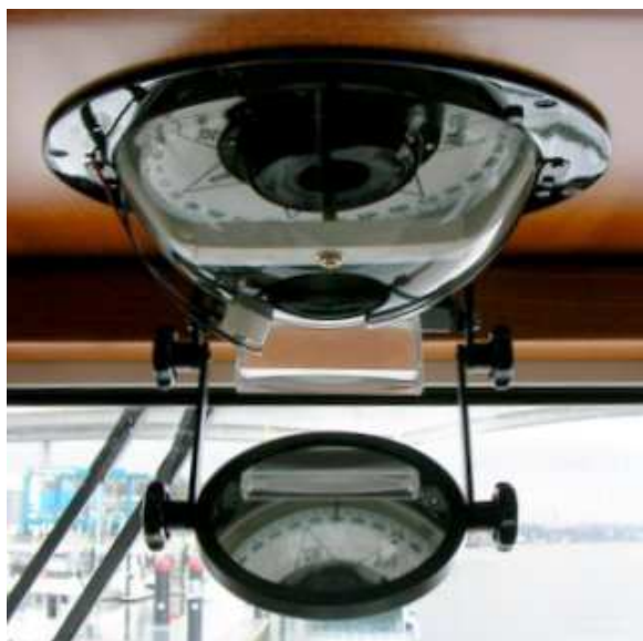
A sinistra – Modello (a cielo) di bussola a riflessione
