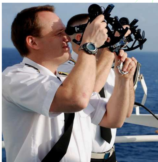
Sul ponte di comando, il Primo Ufficiale e l'Allievo misurano l'altezza del Sole con il sestante. (Il cronometro "MOSTRA" nella mano sinistra).
