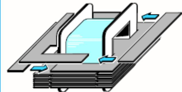
Fig.231 Il tipo di lamierino al silicio più utilizzato è quello formato da una E ed una I. Questi lamierini vanno inseriti all'interno del cartoccio (sul quale sono avvolti gli avvolgimenti primario e secondari) uno opposto all'altro, cioè E - I, poi I - E ecc. Inserendo tutte le E da un lato e tutte le I dal lato opposto si riduce il rendimento del trasformatore.
