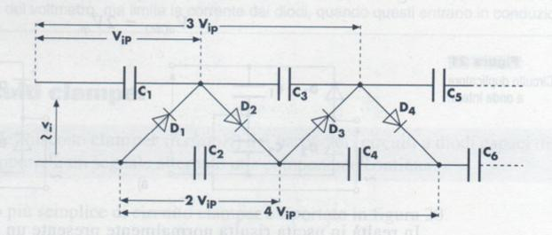
Nella figura 23 tutti i condensatori si caricano a  $2V_{iP}$  a eccezione di  $C_1$ , che si carica a  $V_{iP}$ , pertanto prelevando la tensione ai capi di  $C_2$ , ai capi di  $C_2 + C_4$ , ai capi di  $C_2 + C_4 + C_6$  ecc. si ottengono tensioni multiple pari della  $V_{iP}$ . Se la tensione viene prelevata ai capi di  $C_1$ , ai capi di  $C_1 + C_3$ , ai capi di  $C_1 + C_3 + C_5$  ecc. si ottengono tensioni multiple dispari di  $V_{iP}$ .
