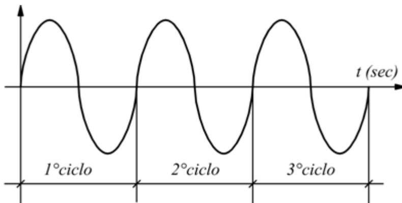
Il periodo di un'onda sinusoidale è il tempo impiegato dall'onda per compiere un intero ciclo, l'onda è caratterizzata dal fatto che compie lo stesso ciclo in modo ripetuto. Il ciclo di un'onda alternata si misura in secondi.
