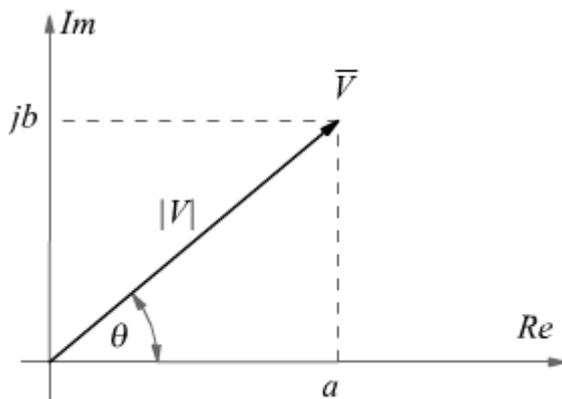
La grandezza elettrica, viene in questo caso rappresentata sul piano dei numeri complessi tramite un vettore  $V$  che ha il suo punto di applicazione nell'origine degli assi.
