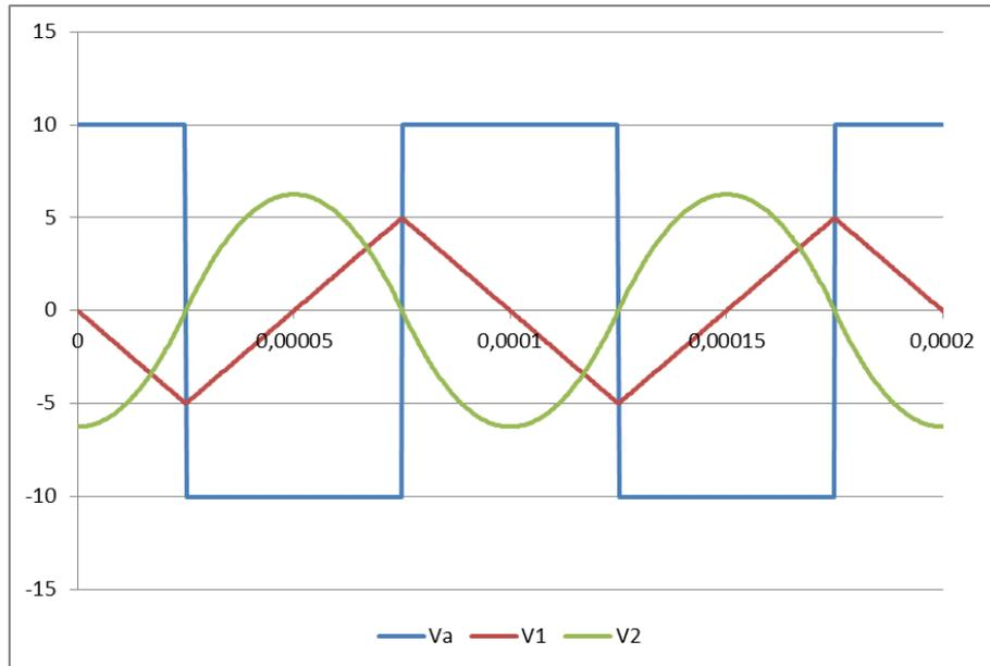
Dalla figura vediamo che il blocco U1 integra il segnale Va che, essendo costante a tratti, genera un'onda triangolare. Il blocco U2 integra rampe positive e negative generando tratti di parabola che approssimano un'onda sinusoidale.
