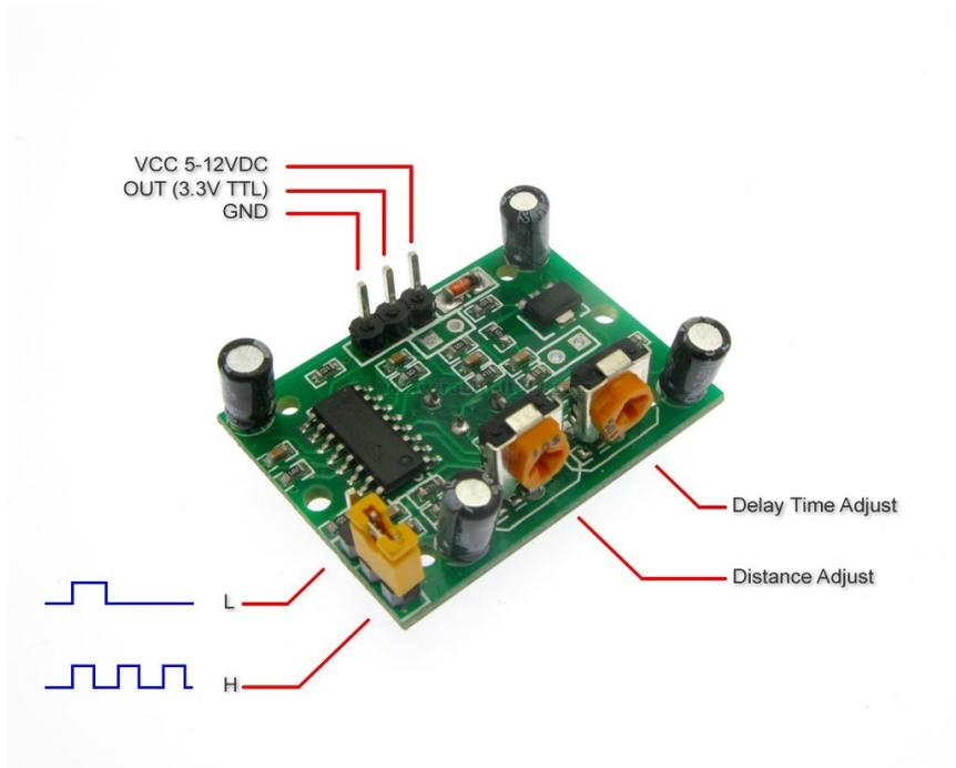
Da notare, una interessante caratteristica, è quella di poter aumentare il periodo in cui l'uscita sia ad un livello logico alto, regolando la manopola di destra. In questo caso, non si fa altro che variare una resistenza, che fa aumentare il tempo in cui l'uscita sia ad 1 logico.
