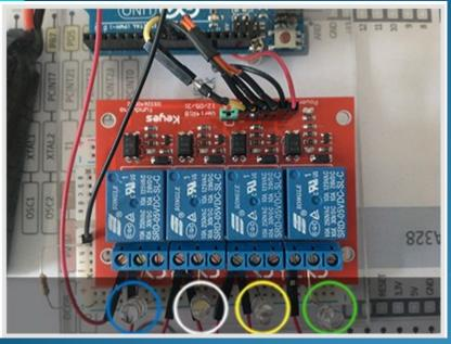
Per verificare che la keyes 4 relay funzioni correttamente colleghiamo 4 led ad alta luminosità, ciascuno ad un relè come in figura.
