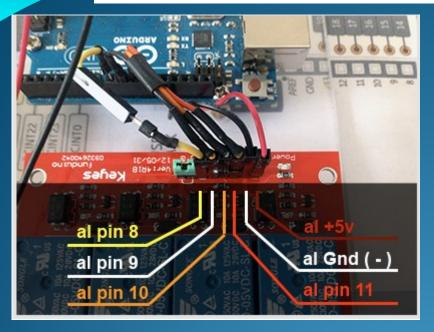
In figura abbiamo riportato i collegamenti per questo test.
