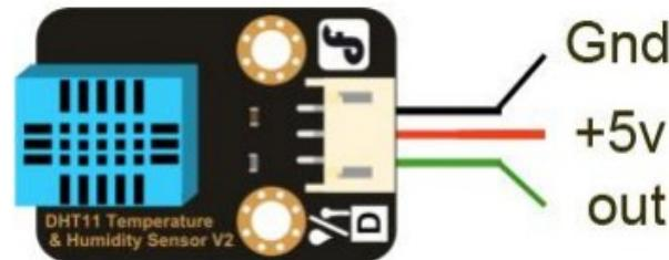
Nell'esempio che vedremo andremo ad interfacciare il DHT-11 con Arduino e mostreremo i valori sul Dispaly LCD I<sup>2</sup>C
