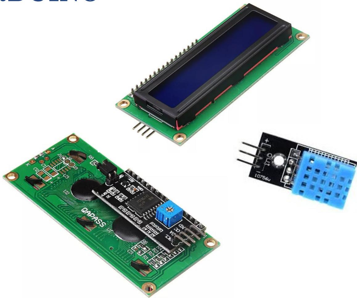
Come abbiamo visto il DHT-11 è un sensore digitale in grado di misurare la temperatura e l'umidità nell'aria.
