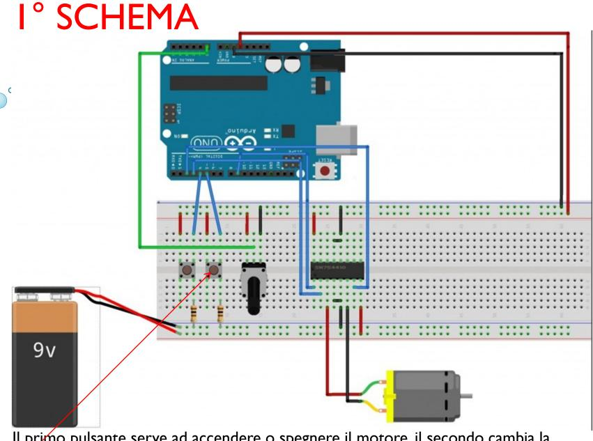
Il primo pulsante serve ad accendere o spegnere il motore, il secondo cambia la direzione di rotazione, mentre il potenziometro aumenta o diminuisce la velocità di rotazione.
