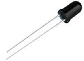
Per quest'ultimo fotodiodo occorrerà collegare l'anodo a massa e il catodo (la parte smussata) al resistore da  $10K\Omega$ .
