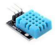
Il sensore DHT11 è un'ottima soluzione per chi ha necessità di controllare, in modo semplice e non molto complesso, temperatura e umidità. Infatti questo sensore con l'adeguata libreria dht11.h è in grado di fornire sia la temperatura che l'umidità.
