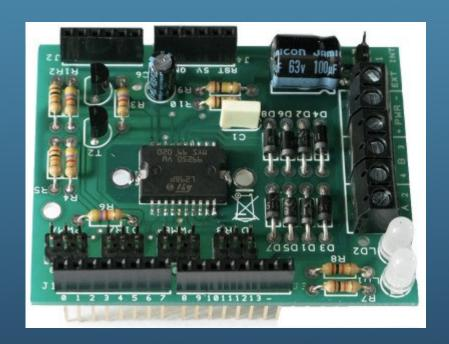
La motor shield FE può essere utilizzata anche per pilotare un motore passo-passo, unipolare o bipolare.
